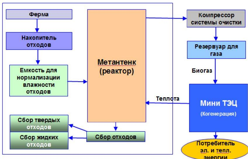
Рис. 1. Технологическая схема получения и применения биогаза
