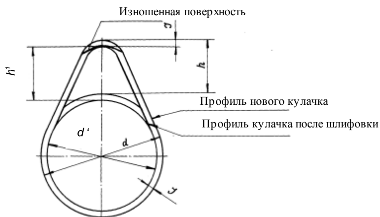
Рис. 4.1. Профиль изношенного и восстановленного кулачков:
